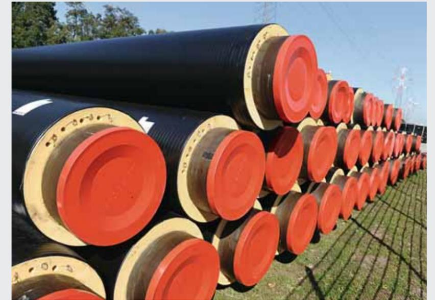
Fernwärmerohre sind gut wärmedämmt, damit auf dem Weg vom Heizkraftwerk zum Kunden möglichst wenig Wärme verloren geht.
