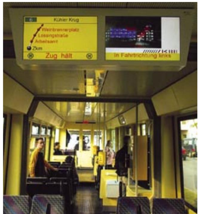
Im Rahmen des Forschungsvorhabens wurden in einem Niederflurwagen der VBK zwei TFT-Bildschirme eingebaut. Ein Bildschirm dient ausschließlich der Fahrgastinformation über den aktuellen Standort, die nächsten Haltestellen, Fahrtziel und Liniennummer. Auf dem anderen Bildschirm werden Programminhalte und standortbezogene Werbung gezeigt.
